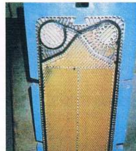
水の入口側は設置されていない。数週間で赤錆が付着。
